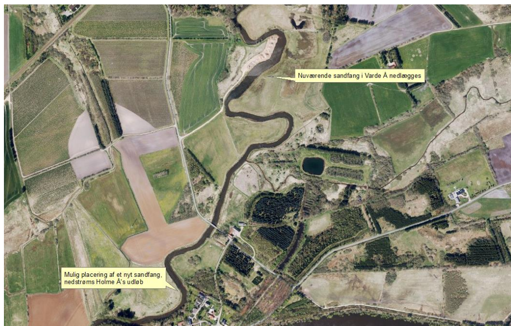
Figur 3-9: Sandfanget i Varde Å flyttes fra opstrøms udløbet af Holme Å til nedstrøms.
